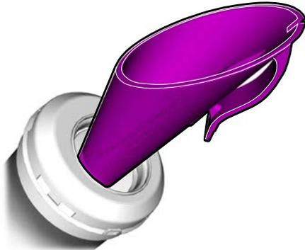
3. Remplissez le réservoir de votre véhicule à l'aide du bidon de carburant.
