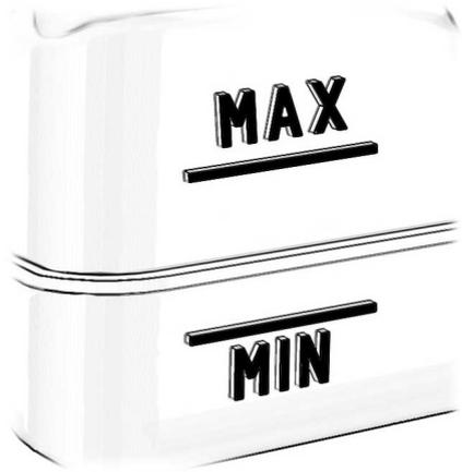
Assurez-vous que le niveau de liquide de refroidissement se situe entre les repères **MIN** et **MAX** sur le réservoir de liquide de refroidissement à la température ambiante. Si le niveau de liquide de refroidissement se situe sur le repère minimum ou en dessous, faites immédiatement l'appoint.
