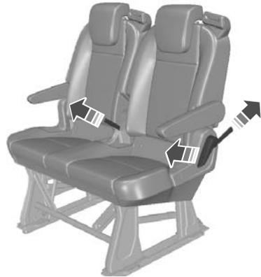
Lorsque le siège est occupé, soulevez le levier ou tirez sur la sangle pour incliner le dossier de siège.
