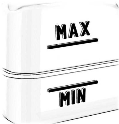
Assurez-vous que le niveau de liquide de refroidissement se situe entre les repères **MIN** et **MAX** à température ambiante sur les réservoirs de liquide de refroidissement du moteur et du moteur électrique. Si le niveau de liquide de refroidissement se situe sur le repère minimum ou en dessous, faites immédiatement l'appoint.
