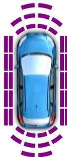
La zone de détection des capteurs est au maximum de 60 cm à partir du côté du véhicule.
