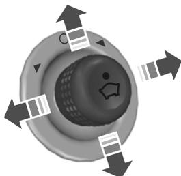
Déplacez la commande de réglage dans la direction des flèches pour régler la position du rétroviseur.
