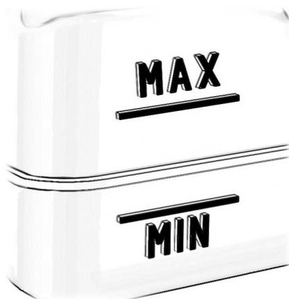
Pour éviter toute contamination du liquide, le bouchon du réservoir doit être maintenu en place et serré au maximum, sauf lorsque vous ajoutez du liquide.
