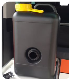
Depósito de aguas residuales
