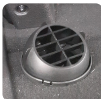
Bocchetta d'aerazione per aria calda
