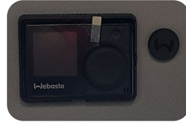
Régulateur de chauffage
